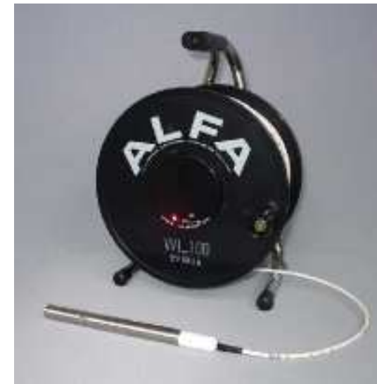
携帯型ロープ式触針式水位計の例
