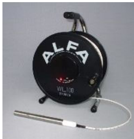
図 1-3-2. 携帯型ロープ式触針式水位計の例
