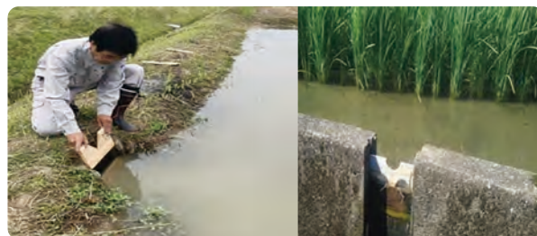
▲V字カットの堰板を設置する
