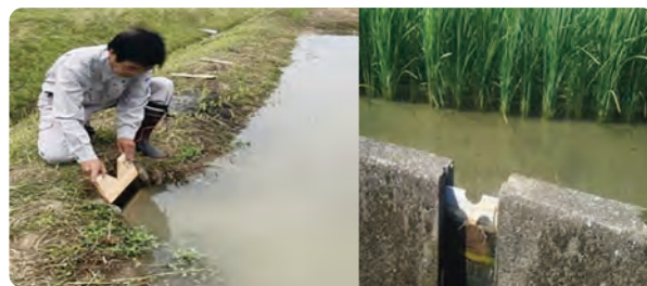
▲V字カットの堰板を設置する
