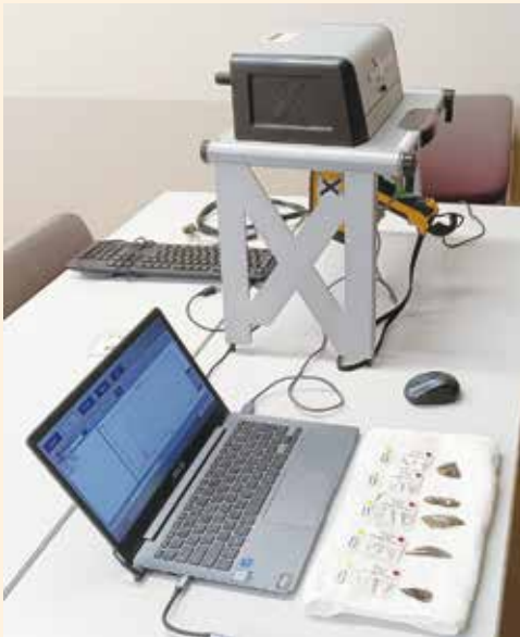
写真 1-3 小塚遺跡出土黒曜石を測定中の可搬型蛍光X線分析装置 (p-XRF)
