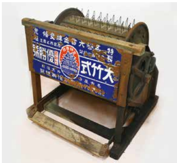
写真 3-43 足踏脱穀機 幅 738mm × 奥行 635mm × 高 630mm
