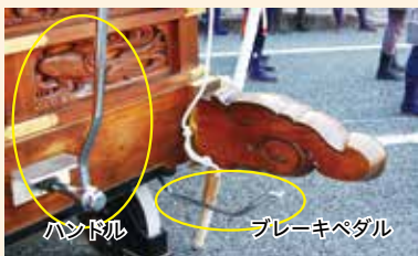
写真3-40 方向転換のハンドルにブレーキペダル（磐穂大和連）
