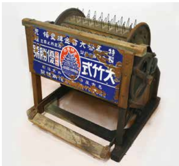
写真 3-43 足踏脱穀機 幅 738mm × 奥行 635mm × 高 630mm
