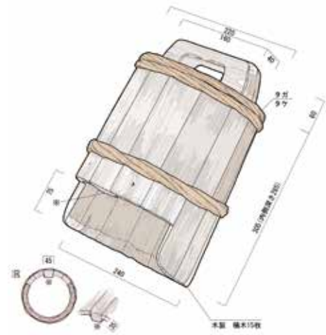
図 3-11 大汲試 (おおくみだめ) 仕込桶からもろみを汲み出すのに使う。もろみ自体が重いので、底板につけた把手と口縁の上部※に手を添えて汲む。
