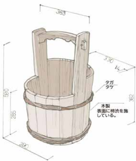
図 3-14 荷担桶 (にないおけ) もろみなどを入れて運ぶ。天秤棒の左右に桶の持ち手の部分を掛け、担いで運んだ。
