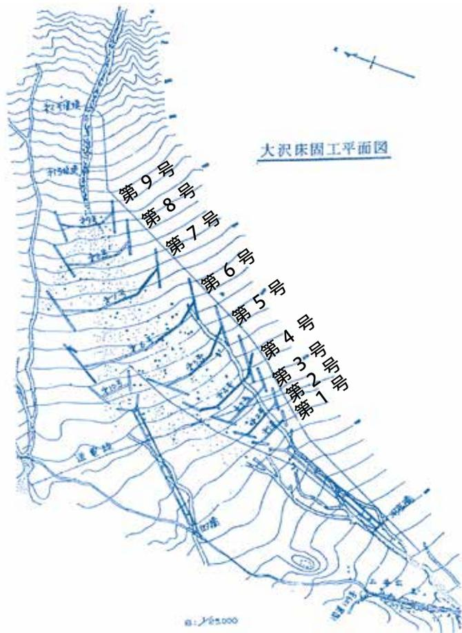
図2-9 大沢扇状地床固工配置平面図
